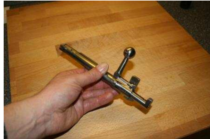
11. Verschluss fertig montiert in gespanntem und gesichertem Zustand
