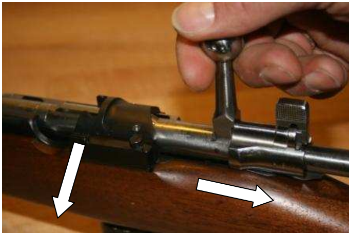
3. Schosshalter nach links ziehen, Verschluss nach hinten heraus ziehen
