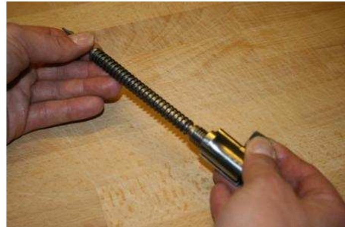
7. Schlagbolzen mit aufgesetzter Schlagbolzenfeder von vorne ins Schließchen einsetzen
