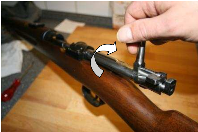
12. Verschluss einsetzen und spannen
