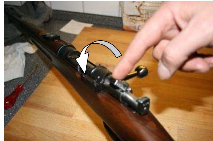
12. Sicherungsflügel nach links umlegen
