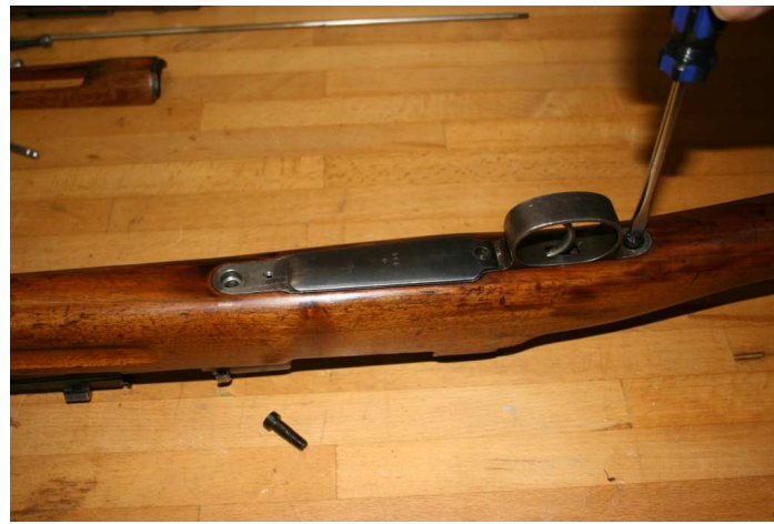
8. Magazinkastenschrauben unten heraus schrauben
